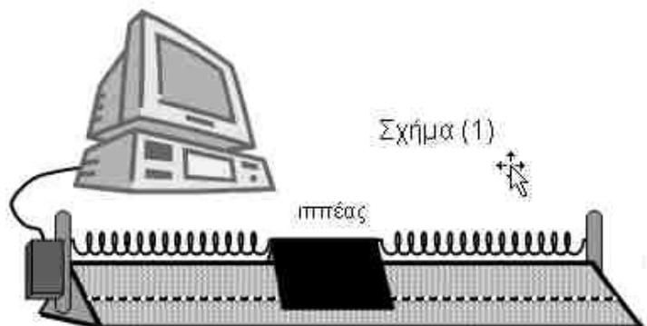
κρα των ελατηρίων στερεώνονται στον αεροδιάδρομο και το σώμα βρίσκεται στη θέση ισορροπίας του όπως φαίνεται στο σχήμα (1). Το σώμα εκτρέπεται από τη θέση ισορροπίας του και με κατάλληλο απτήρα αφήνεται ελεύθερο ενώ αυτόματα τίθεται σε λειτουργία το καταγραφικό.
